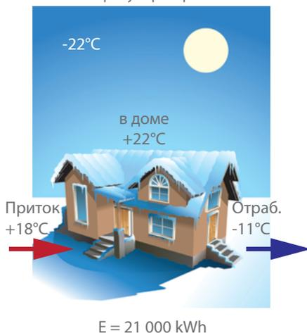
Пример применения пластинчатого рекуператора
